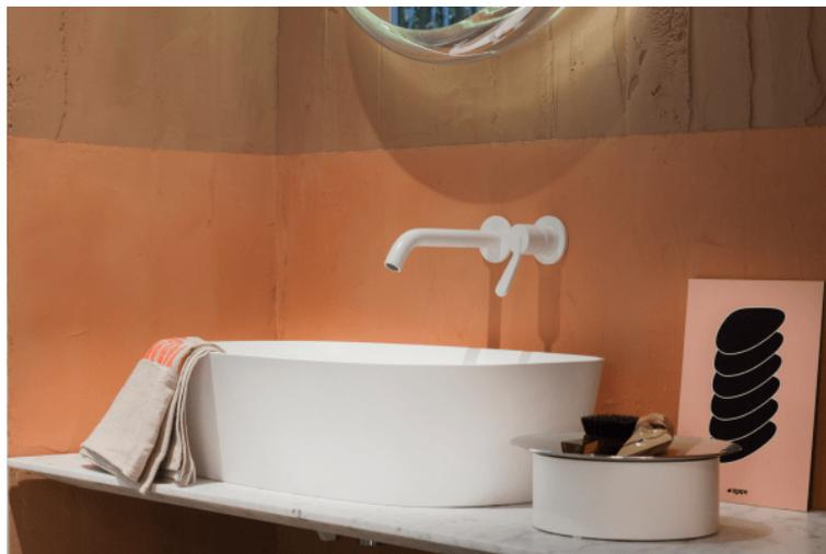
Lavabo da appoggio in Cristalplant® biobased bianco o bicolore (esterno verniciato grigio scuro RAL7021 o grigio chiaro RAL7044); senza foro per rubinetto, a scarico libero. Il lavabo è completo di piletta con calotta Cristalplant® biobased bianco a filo della sagoma interna del lavabo (.MET0723).
