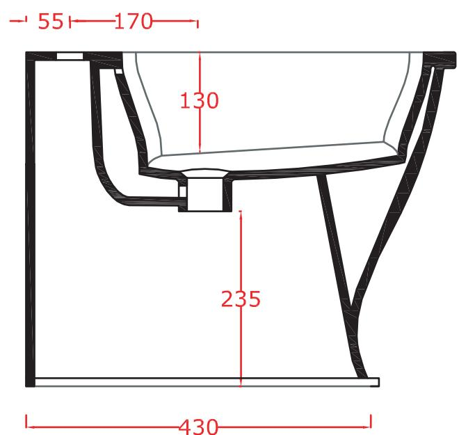
N.B. Le misure indicate possono subire una variazione dell'0,6% circa, dovuta ad usura stampi e a variazioni delle caratteristiche tecniche relative alle materie prime che compongono l'impasto.
